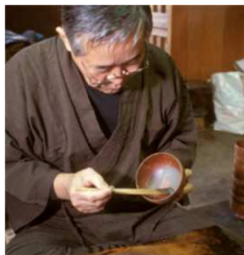
木地を堅牢にする下地工程
